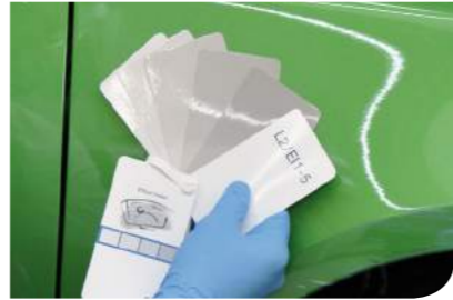
필, 메탈릭 색상의 경우 측정값에 따른 입자 칼라 카드 비교 및 확인으로 보다 정확한 색상값을 찾을 수 있습니다.
