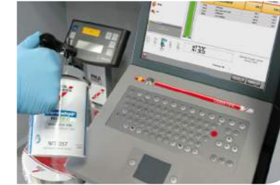
필요한양의 페인트를 배합비율에 맞게 준비합니다. 측정 저울과 프로그램 연동을 통해 보다 효과적으로 배합 작업을 진행할 수 있습니다.
