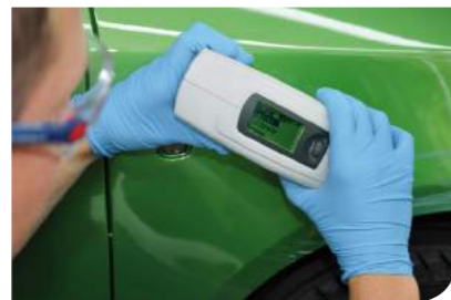
엑솔타의 어라이어 칼라 색측기를 사용하여 해당 판넬의 색상값을 측정합니다.
