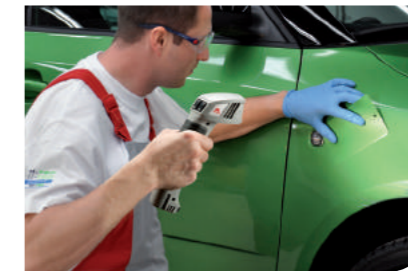
작업된 시편을 차량과 비교하여 색상 및 입자감을 확인합니다.
